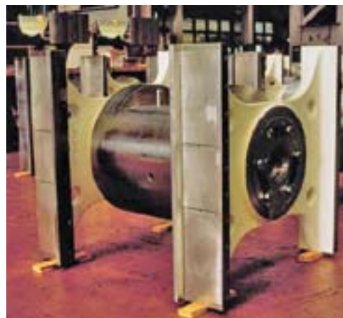
Σχ. 5.8δ Ζύγωμα δίχρονης αργόστροφης πετρελαιομηχανής (πηγή: Wärtsilä).
